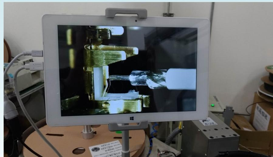
3. IPEX端子壓著視覺系統輔助校正。
